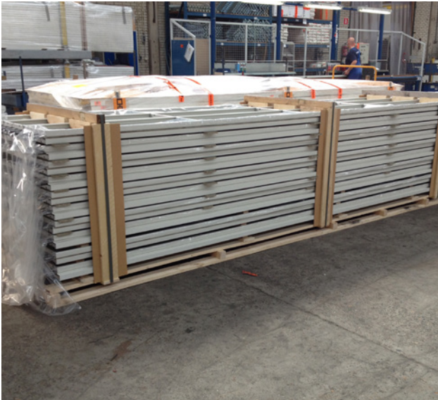
Transporteinheit (maximal 20 gestapelte Platten pro Palette)
